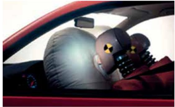
Figura 2: Despliegamiento del dispositivo del air bag. Un instante cargado de riesgo de lesiones. Tomado de Collision Safety Institute 04
